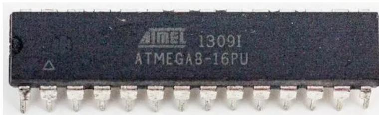
Рисунок 1 – Микроконтроллер ATMEGA8
