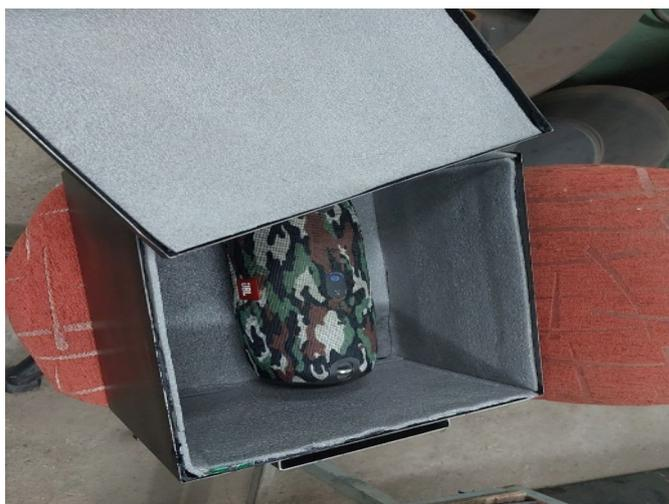
Рисунок 6 – Шумоизоляционный слой
