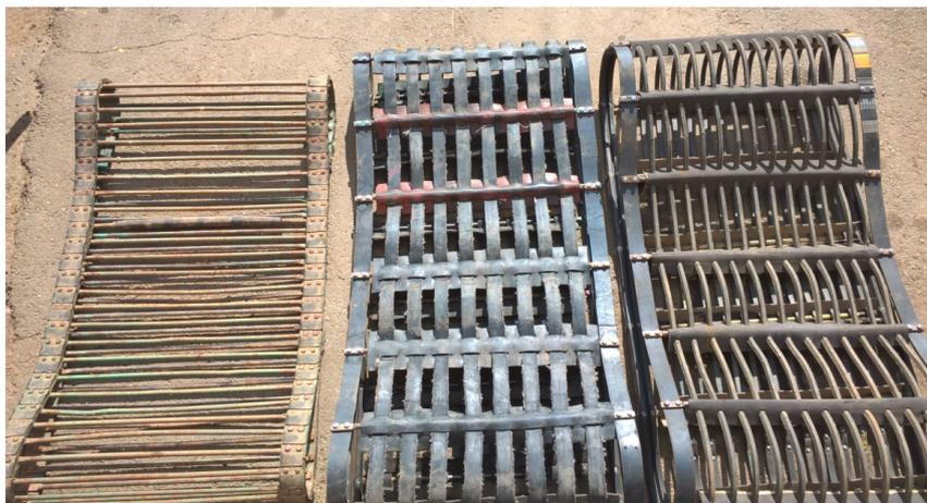
Рисунок 1 – Облегченные транспортеры с повышенной эластичностью
