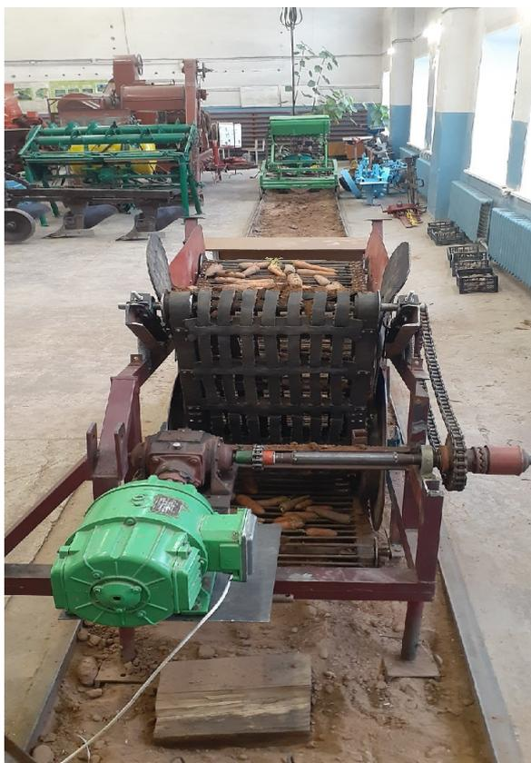
Рисунок 2 – Размещение транспортера на экспериментальной установке
