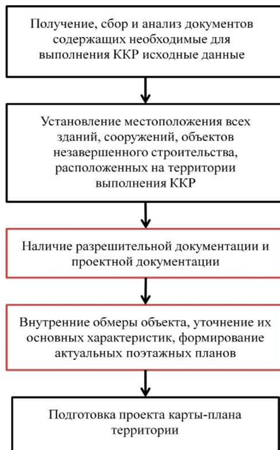
Рисунок 5 – Технологическая схема постановки на кадастровый учет объектов
