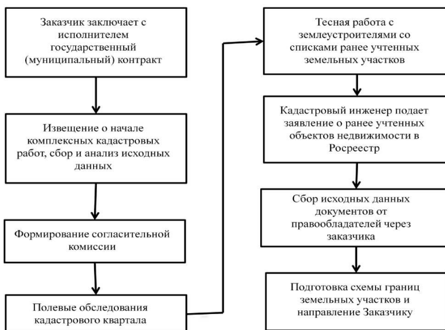
Рисунок 7 – Технологическая схема порядка проведения комплексных работ на подготовительном этапе
