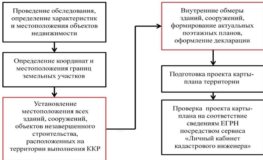
Рисунок 8 – Технологическая схема порядка проведения кадастровых работ на первом этапе
