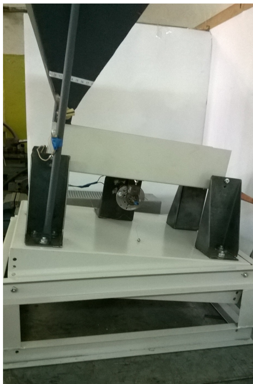
Рисунок 6 – Экспериментальная установка виброгрохота
