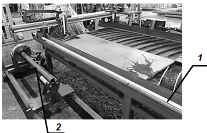
Рисунок 2 – Расположение дополнительного модуля-трубореза: 1 – станина установки PLAZMA-15/30, 2 – модуль-труборез
