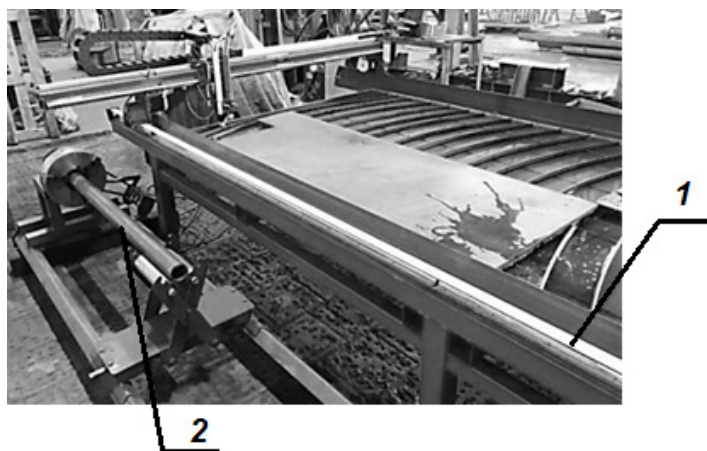
Рисунок 2 – Расположение дополнительного модуля-трубореза: 1 – станина установки PLAZMA-15/30, 2 – модуль-труборез
