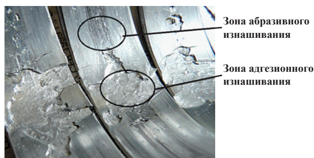
Рисунок 2 – Характерный износ покрытий из баббита в условиях эксплуатации без смазки
