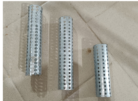
Рисунок 3 – Элементы цилиндрической решетки трубчатого измельчителя с диаметрами 8, 6 и 4 мм
