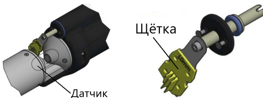
Рисунок 1 – Конструкция датчика и узла очистки со щёткой
