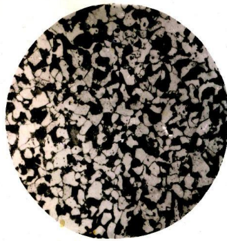
Рисунок 5 – Микроструктура углеродистой стали 250×
