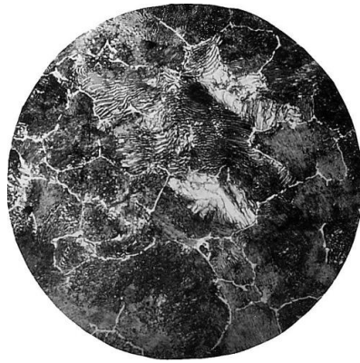
Рисунок 7 – Микроструктура углеродистой стали 200)×
