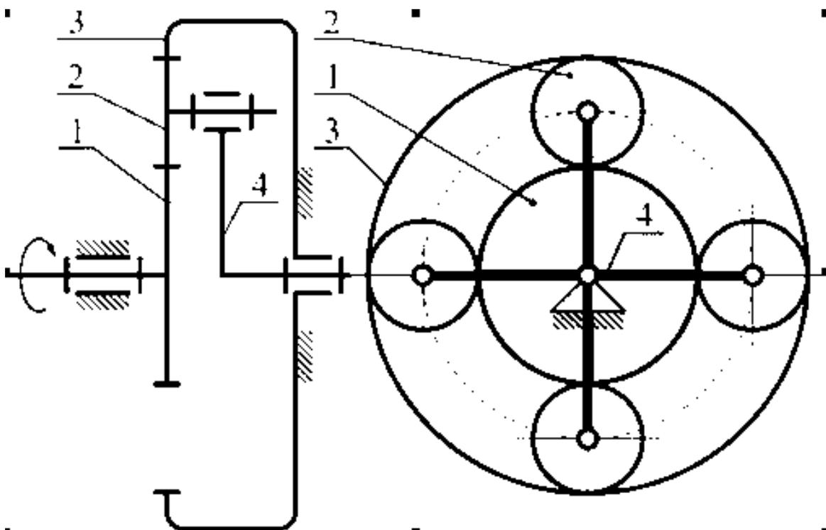
57. Определить число зубьев сателлита 2 и корончатого колеса 3 из условия соосности и заданного передаточного отношения  $U_{1-4} = 5$ , если  $z_1 = 20$ .
