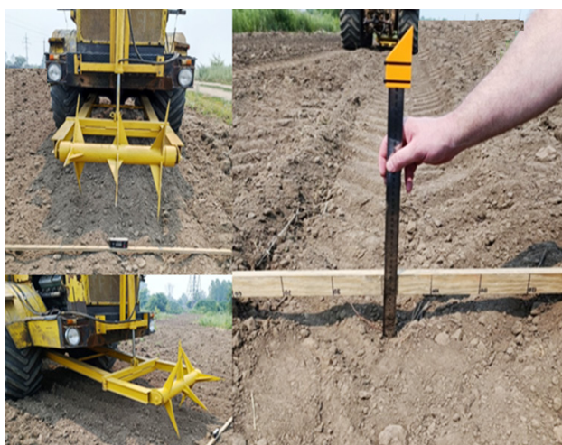
Рисунок 6 – Фрагмент измерения глубины колеи после прохода трактора по полю
