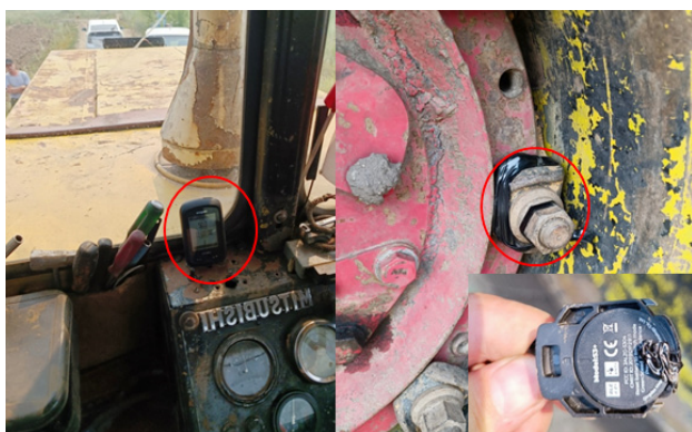
Рисунок 7 – Приборно-регистрационный комплекс Magene C406 Pro и датчик буксования
