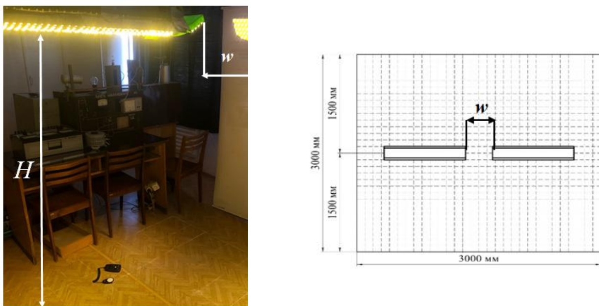
Рисунок 4.25 – Проведение эксперимента измерения освещенности при последовательном расположении светильника с \alpha_1 и отражателем
