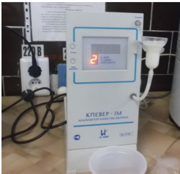
Рисунок 5.7 – Анализатор качества молока - Клевер -1М
