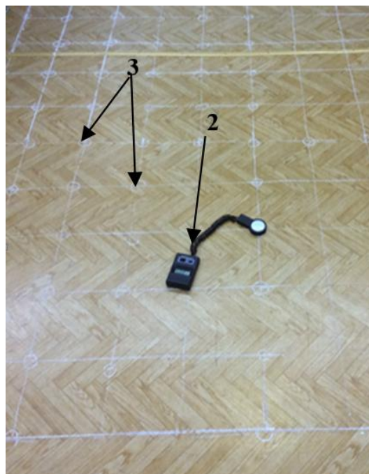
Рисунок 4.6 – Проведение эксперимента на конструкции лабораторного стенда над сеткой при различной высоте подвеса: 1 – экспериментальный опытный образец осветительного прибора на основе светодиодов; 2 – Люксметр Аргус-07; 3 – экспериментальная площадка с точками замера
