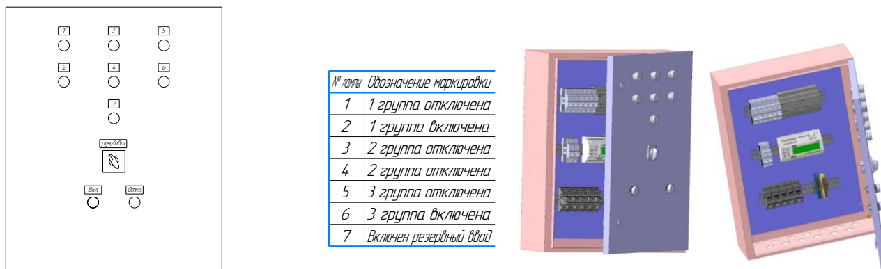
Рисунок 3.43 – Пример расположения электросветовой индикации и ручного управления на двери шкафа управления освещением в птичнике
