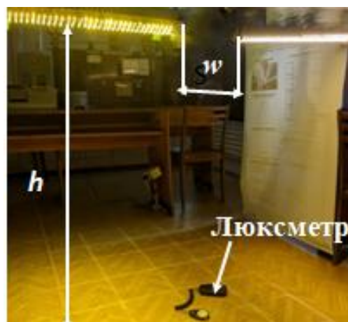
Рисунок 4.15 – Измерение освещенности при последовательном расположении светильников
