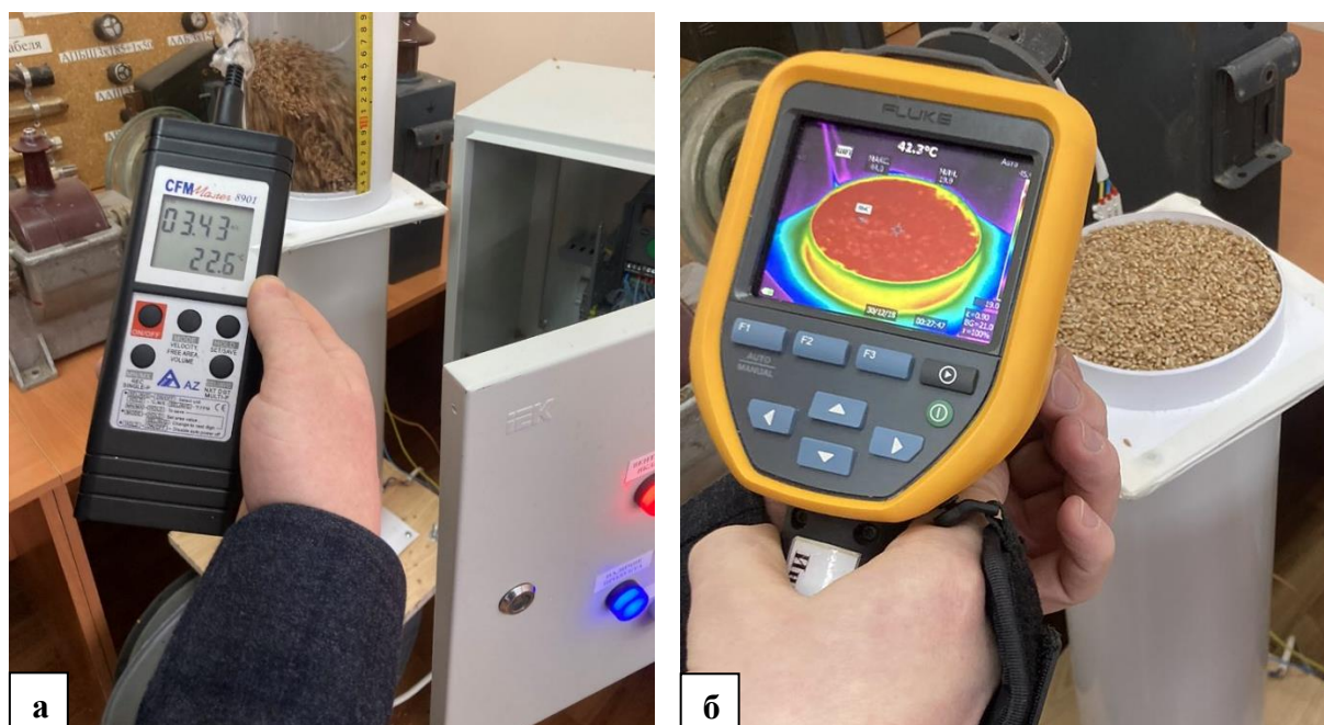
Рисунок 4.12 – Проведение экспериментальных исследований: а) измерение скорости оживающего агента термоанемометром AZ8901 б) определение температуры зерна в процессе сушки тепловизором Fluke TiS45
