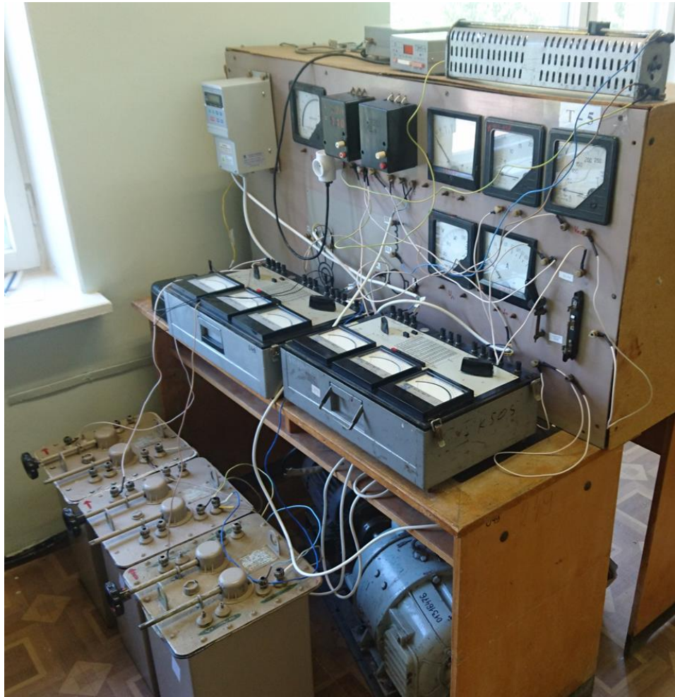
Рисунок 3.3 – Экспериментальная установка для испытания частотно-регулируемого асинхронного двигателя АИР100S4
