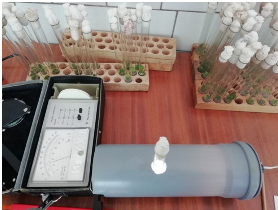
Рисунок 2.4 – Светопроектор для определения листовой поверхности меристемных растений
