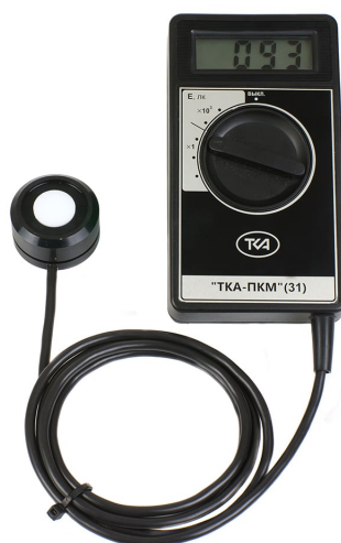
Рисунок 3.12 – Общий вид прибора «ТКА-ПКМ» для измерения облученности
