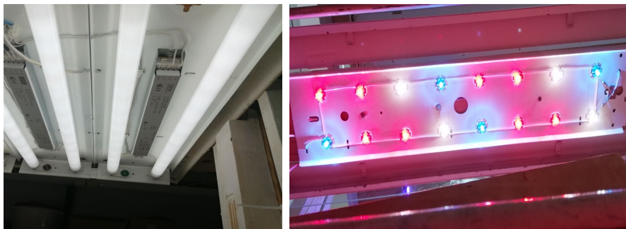
Рисунок 3.3 – Сравнимые фитооблучатели а – разрядный с лампой Osram L 10W/640 (контроль); б – LED фитооблучатель, работающий в непрерывном и импульсном режиме
