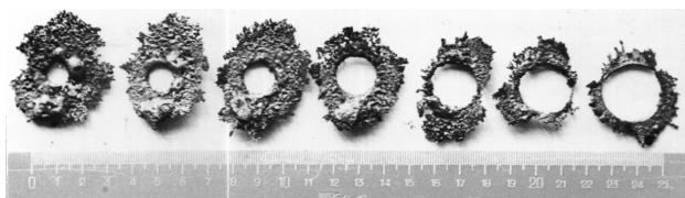
Рисунок 5 – Расплавленный металл электродной проволоки на передней панели ( G_{n.n} ) улавливателя при различных диаметрах проходного сечения экрана: 10, 12, 14, 17, 20, 22, 24 мм
