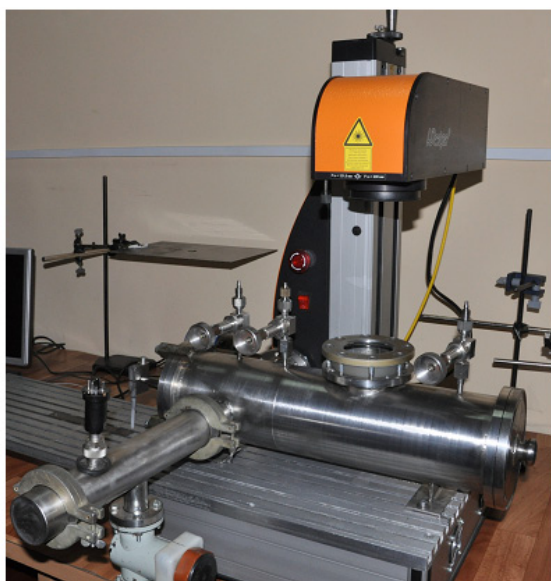
Рисунок 1 – Экспериментальная установка для получения керамических покрытий
