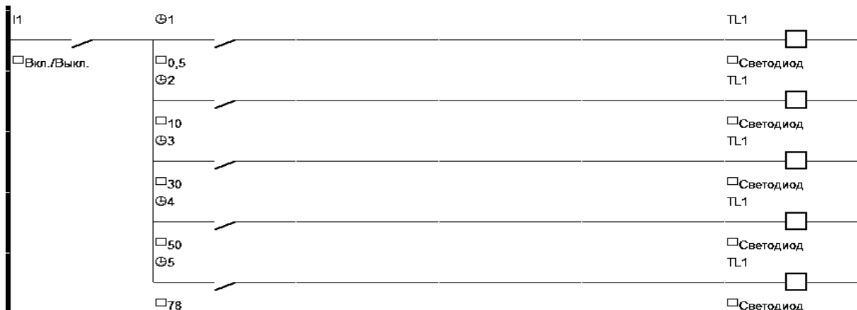
Рисунок 5 – Система управления на языке лестничных диаграмм (LADDER) Zelio Logic для Перу
