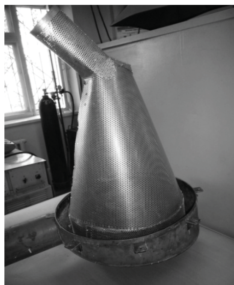
Рисунок 3 – Конструкция сепарирующего решета и порядок установки в циклоне
